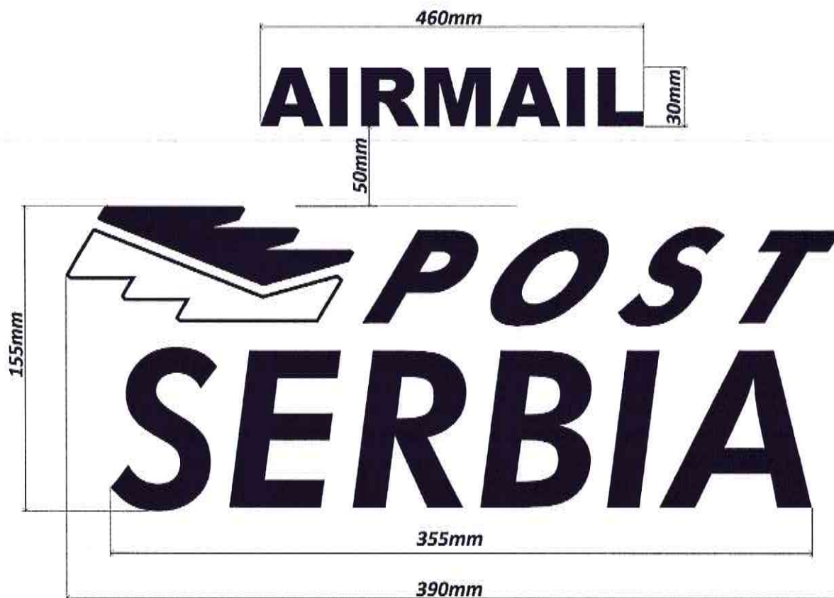
Цртеж бр. 6 - Изглед и димензије лоба на врећи за авионске пакетске пошиљке полиестер плава 1200×1600mm
