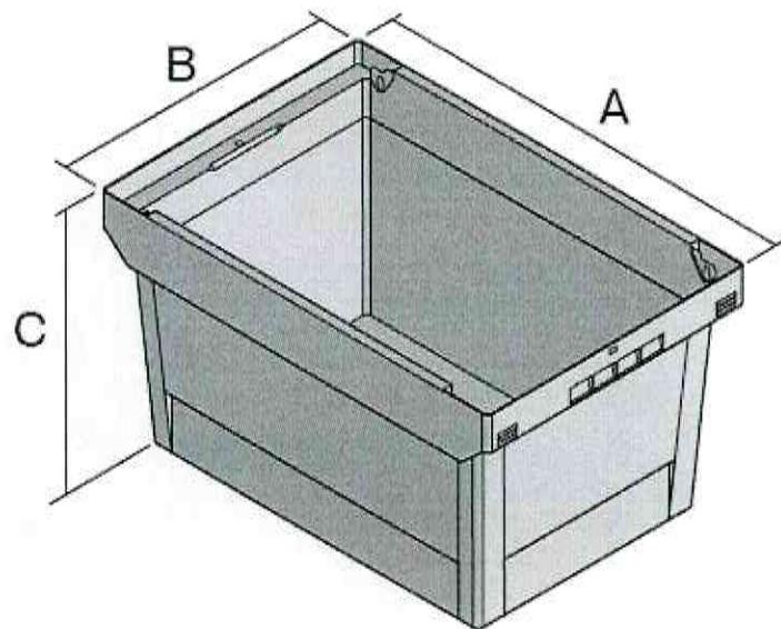
A – дужина: 600 mm (дозвољено одступање  $\pm 2$ mm);
