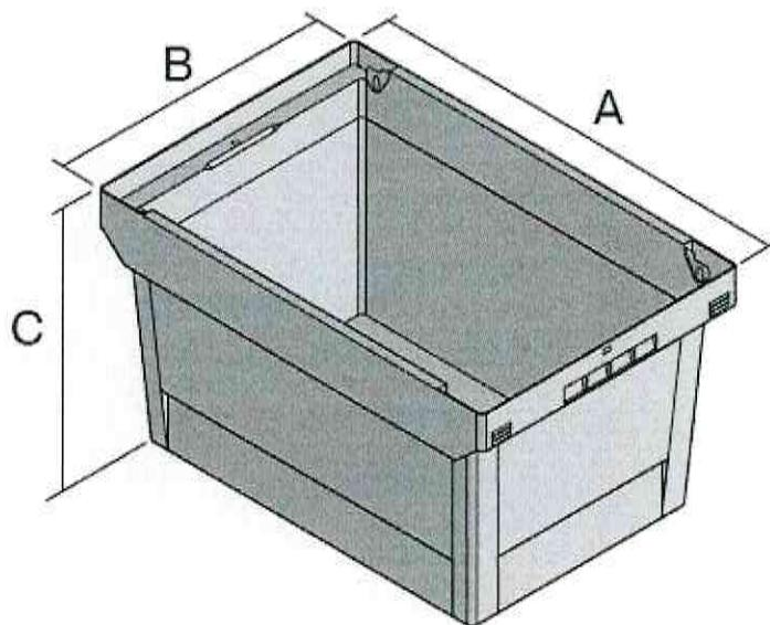
A – дужина: 600 mm (дозвољено одступање  $\pm 2\text{mm}$ );
