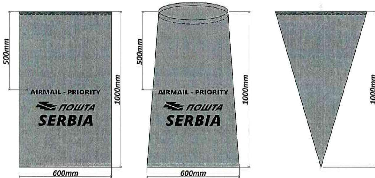
Цртеж бр. 3 - Изглед и димензије вреће за авионске писмоносне пошиљке полипропилен плава 600×1000mm
